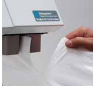
**Schritt 1:** Drücken Sie eine der 10 Tasten, um einen Schaumbeutel zu erzeugen. Trennen Sie den expandierenden Schaumbeutel an der Perforation ab.
